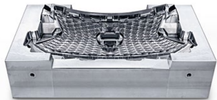
模具/汽车 散热器格栅的注塑模 材质：工具钢 位置公差：10–15 μm
