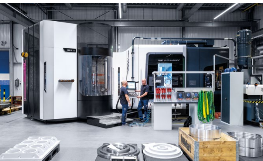
配磨削循环的DMC 125 FD duoBLOCK将表面质量提高到0.4 μm Ra并将圆度提高到5 μm。
