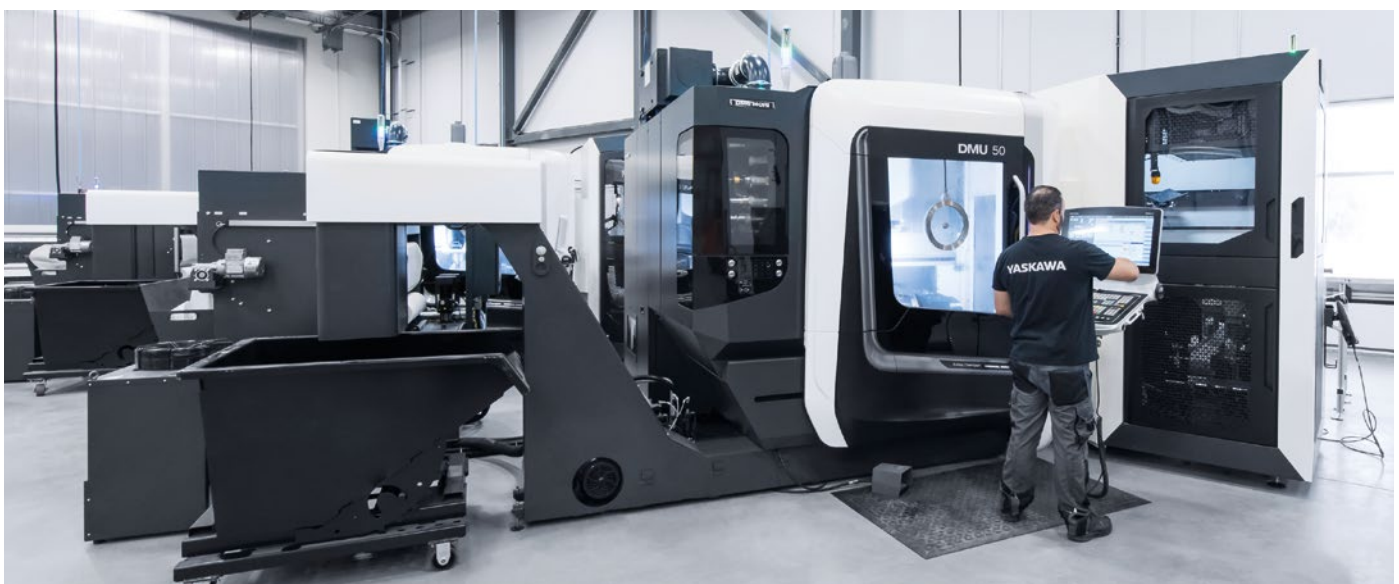
配WH 6 Cell的DMU 50加工中心提供自动生产能力，Attabotics用该机加工基础立柱和其它部件，满足市场的旺盛需求，包括满负荷生产时。
