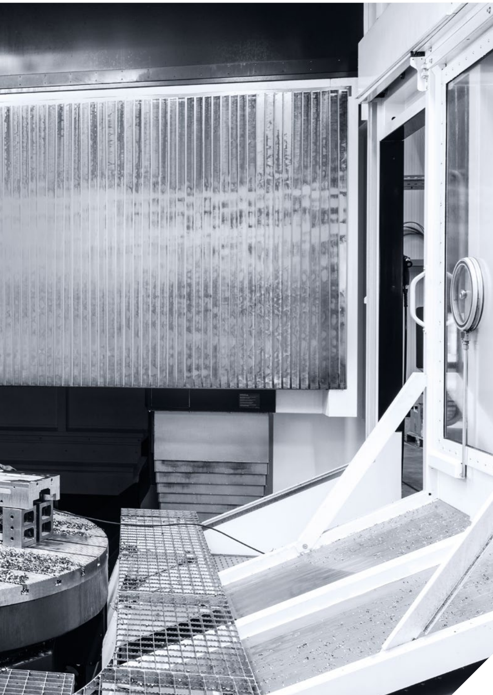
DMU 340 P加工中心的加工区达 3,400 × 3,400 × 1,600 mm。工作台最大承重达16t。
