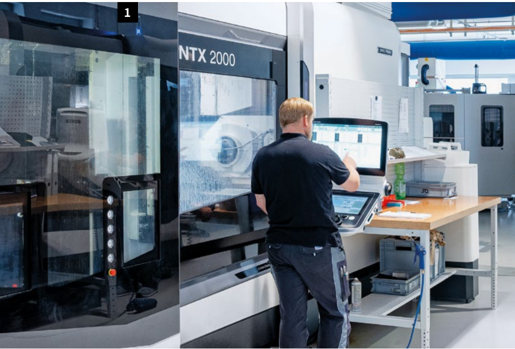
1. SQ Products共用6台NTX 2000车 / 铣中心加工肩骨植入体中的骨座,显著优化工艺,将生产周期从数周时间缩短到仅一天。 2. SQ Products生产的医疗植入体满足苛刻的精度要求。
