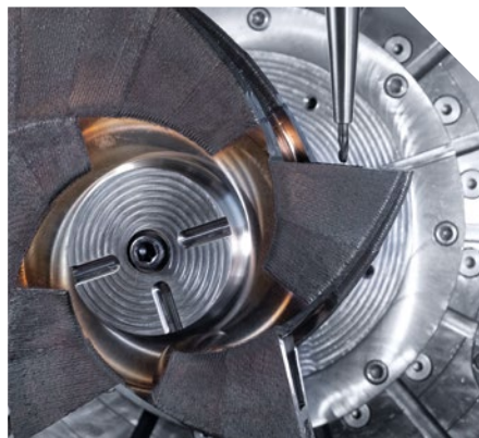
由于复杂叶轮的原制造方法需要制作铸模,周期时间较长,需要25周的时间。用LASERTEC 65 3D hybrid 增材制造机床将该工件生产周期缩短到一周以内。
