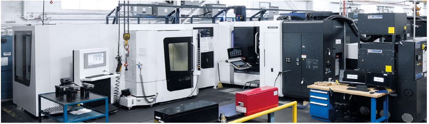
在Top Grade Molds的机床群中,已有4台NHX 5000卧式加工中心,由两套直线托盘库将其自动化。
