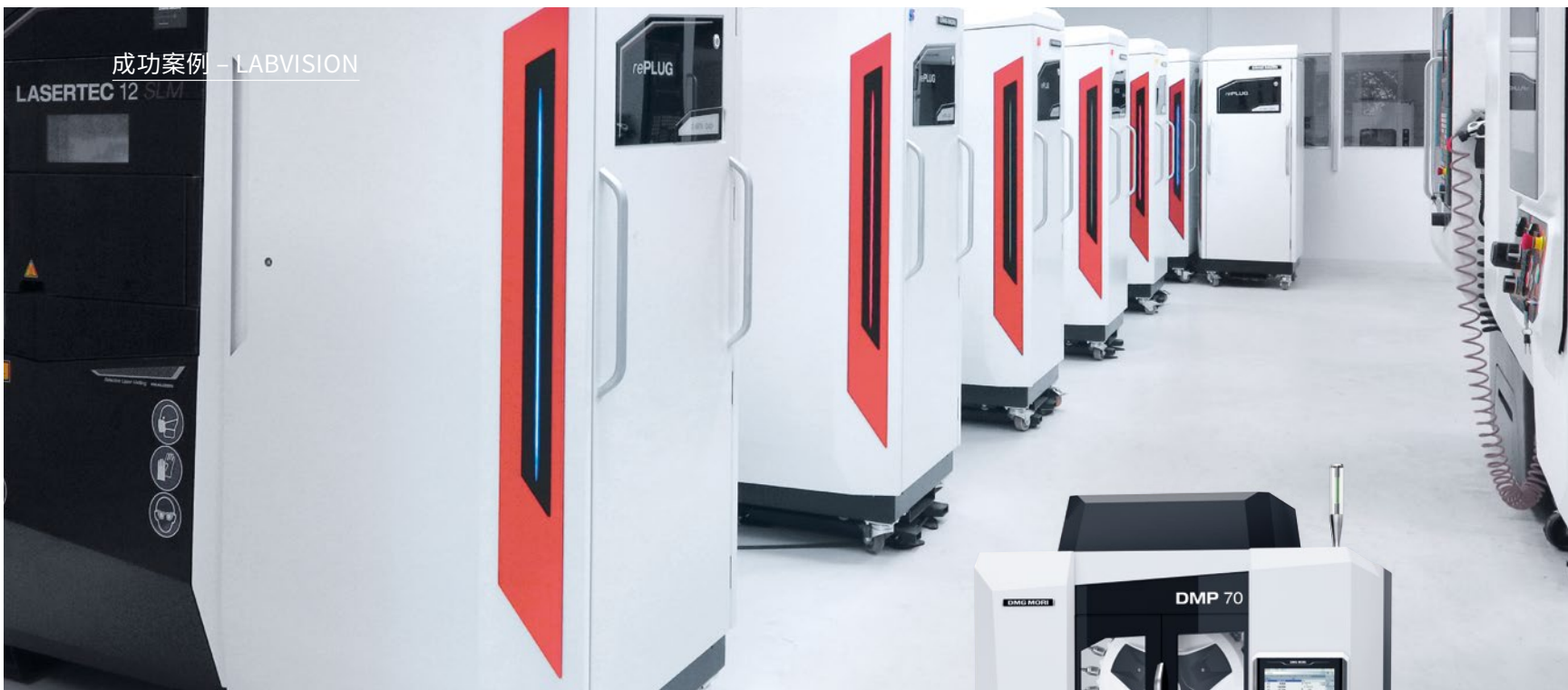
增材制造和高精度铣削：六台LASERTEC 12 SLM、两台DMP 70和一台MILLTAP 700，LABVISION用这些机床组成一条牙科复合加工工艺链。
