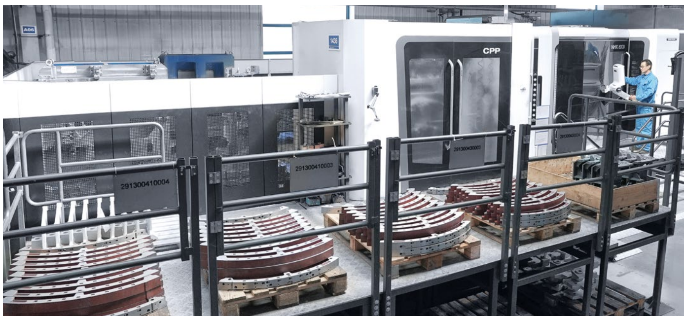
特吕茨施勒使用配托架托盘库(CPP)的NHX卧式加工中心自动加工大型工件
