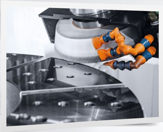
高精度工件是NAMCO变速箱的重要部件。 磨削后，表面质量达到Ra 0.17 μm
