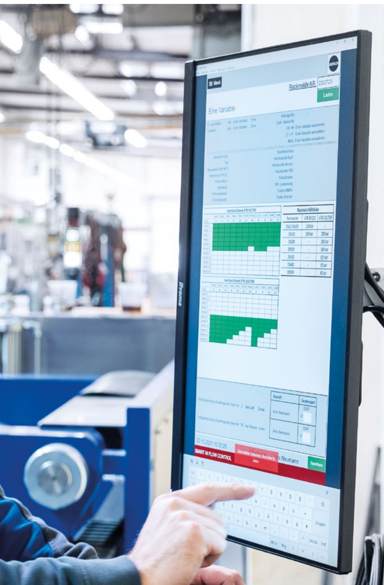
组装班组用TULIP APP应用程序接收组装专用的任务说明，确保正确地组装。
