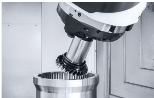
铣削和车削 齿轮加工, 模数可达11 (例如, DMC 80 FD duoBLOCK)
