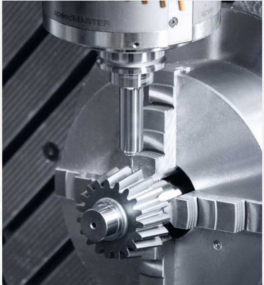
对于小型特殊齿轮，NAMCO可选的机床包括配PH 150自动化系统的DMU 65 monoBLOCK铣削加工中心。
