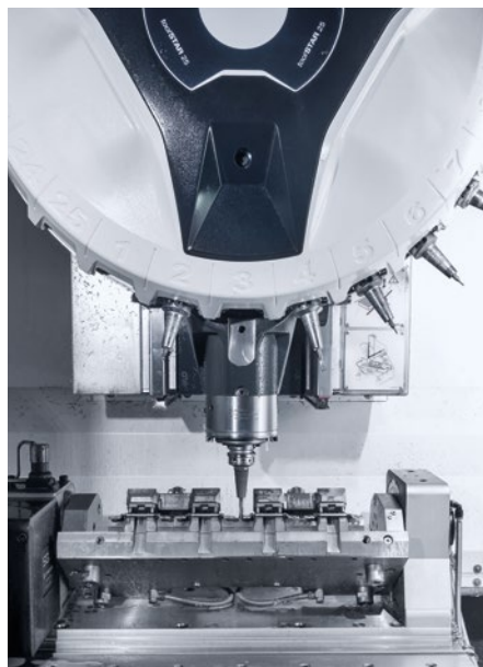
为加工特别开发的夹具,可夹持四件工件。
