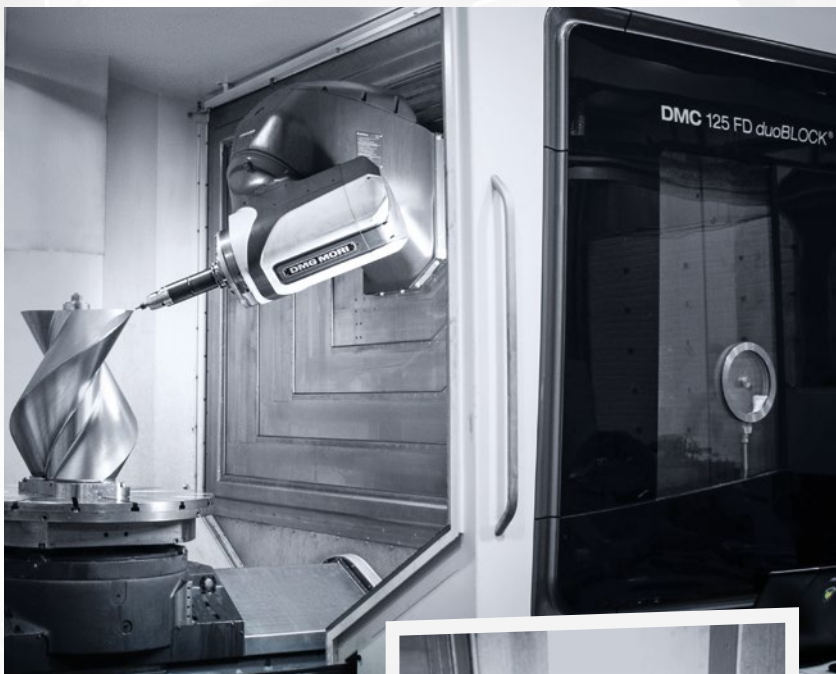
NAMCO用DMG MORI软件gearMILL编程齿轮加工程序和用DMC 125 FD duoBLOCK铣削加工中心加工齿轮和其他复杂工件。
