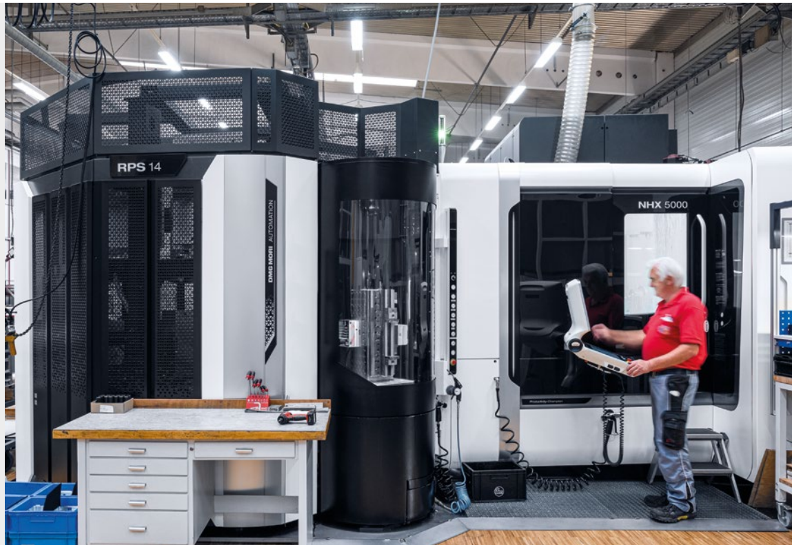
Heppler使用3台NHX 5000卧式加工中心自动生产不锈钢液压件，配RPS 14回转托盘库系统后全部自动化。
