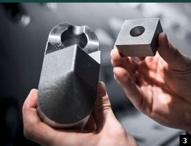
3. Micromat破碎机的Mono-Fix刀座和刀片。
