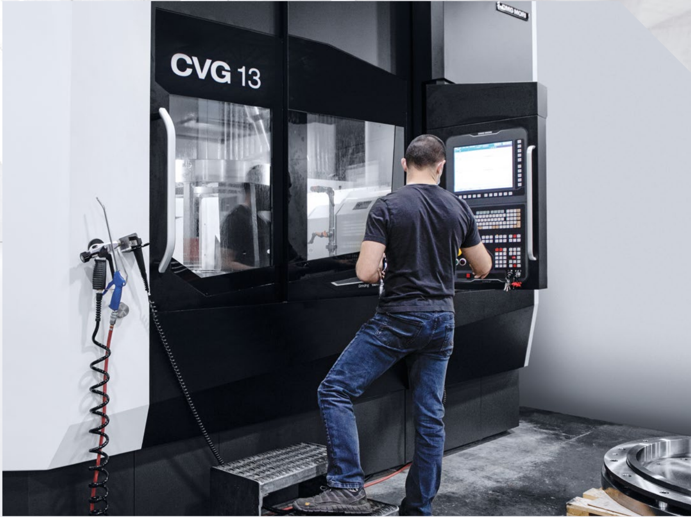
NAMCO在精加工中选用的机床之一是CVG 13。可磨削大型工件，工件直径可达1,300 mm。
