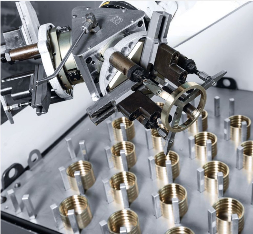
Robo2Go堆垛式工件库可提供充足的件位,可确保CTX beta 800 TC全天24小时保持生产。
