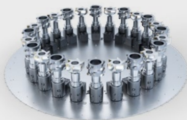
多达22个HSK63刀具 最大ø90 × 440 mm和 最大重量30 kg
