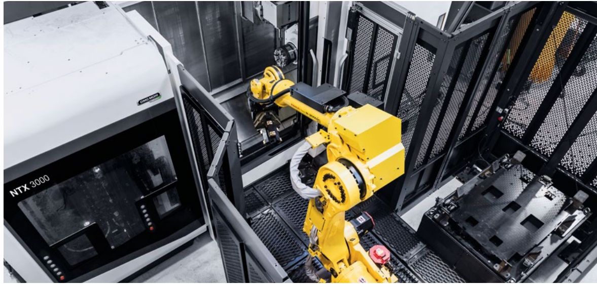
两台配Robo2Go和MATRIS自动化系统的NTX 3000可自动加工数小时。
