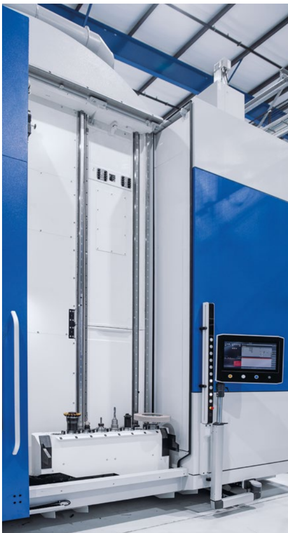
TH-AGV与装刀位配合可全自动地一次更换多达8把一组的刀具。
