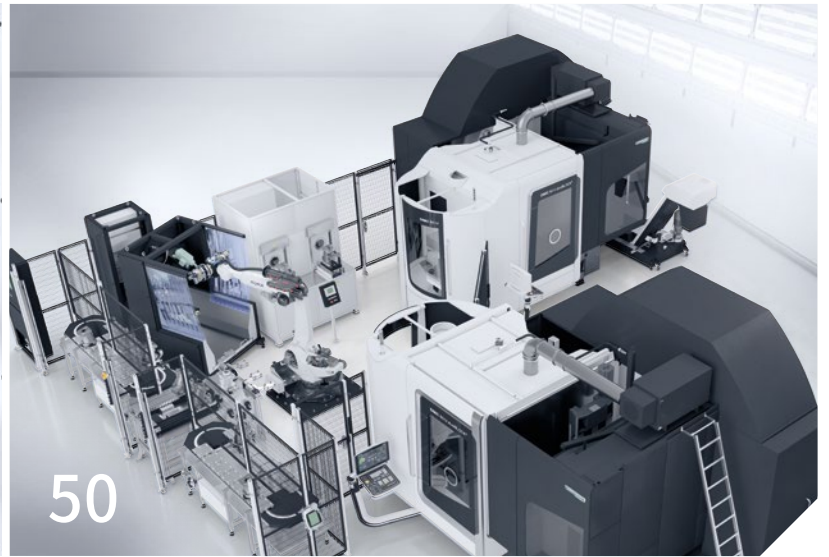
博世力士乐用数字工程将自动生产单元直接投产，其中含两台DMC 80 H duoBLOCK加工中心、机器人、清洁等工位。在投产前，已完成全部工艺和运动顺序的试用和测试。
