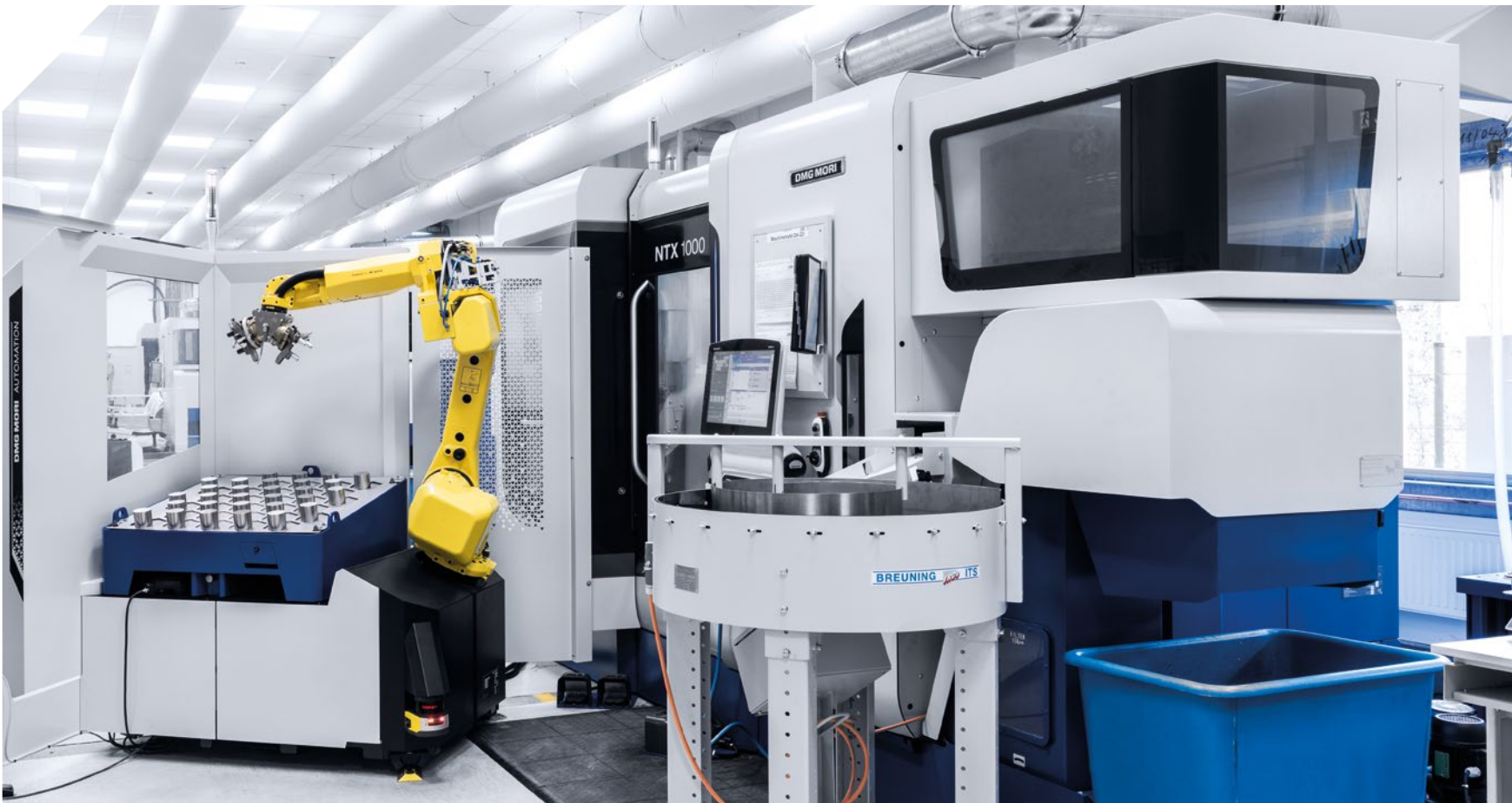
LINK公司最近引进的机床是两台配Robo2Go的NTX 1000生产系统, 自动生产髌臼杯。
