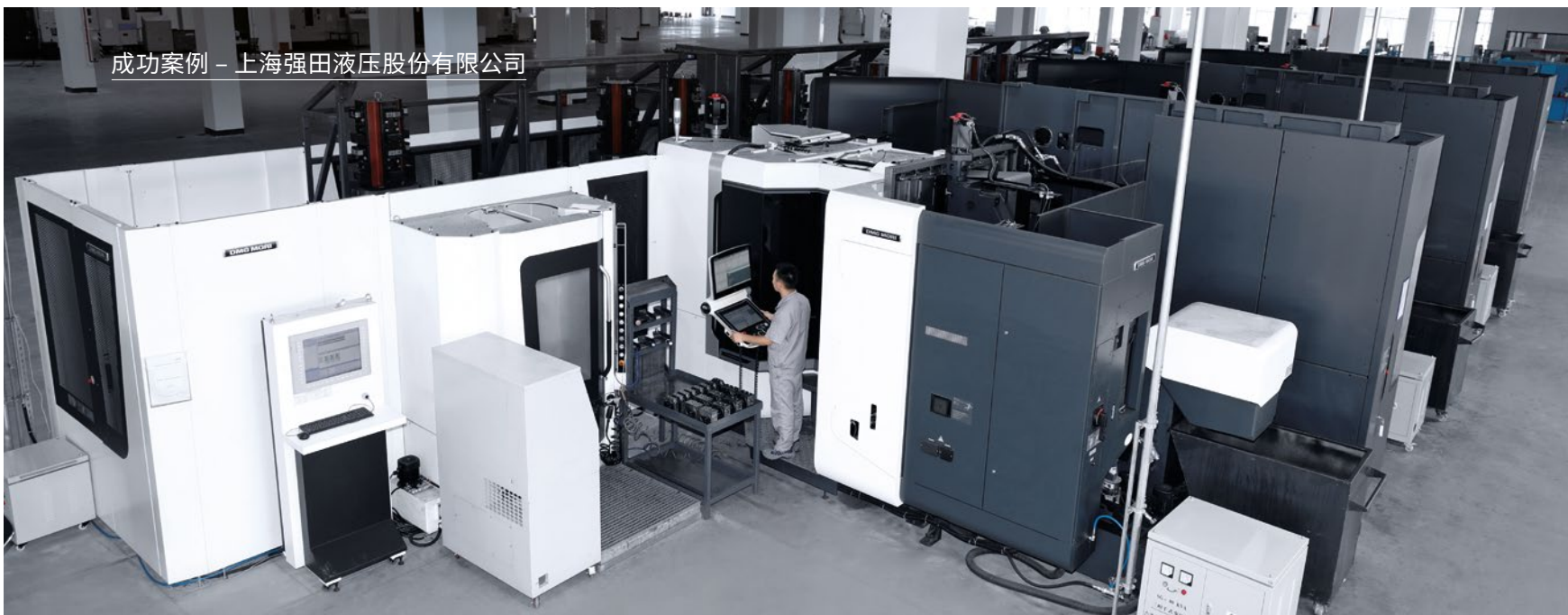
强田液压的生产解决方案由三台NHX 5500卧式加工中心并配28盘位和一个装夹位的直线托盘库系统组成。
