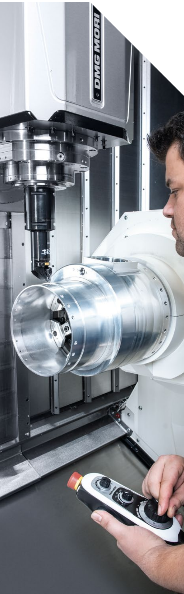
用DMG MORI特有的技术循环偏心车削X射线球管的壳体和盖板。
