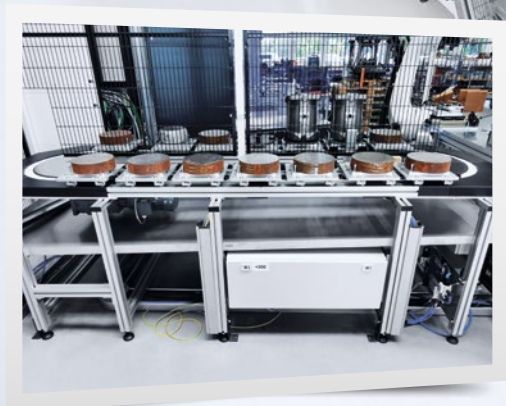
1. 回转托盘库系统将工件运入和运出， 确保在加工期间无需装夹工件。
