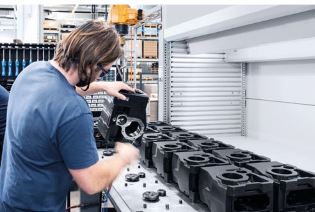
自动化的小件工件库为生产单元提供工件。也在工件库中存放加工后的工件。
