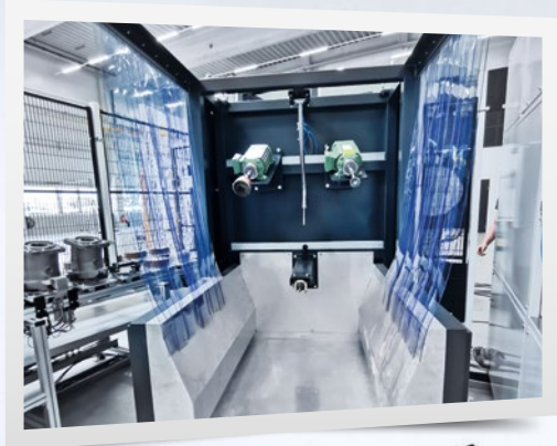
2. DMC铣削加工中心完成铣削后， 在去毛刺位完成工件去毛刺。
