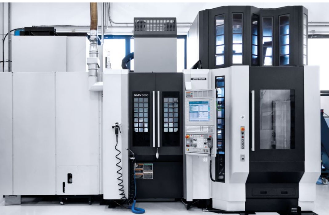
AWC托盘库的盘位数多达34位，NMV 3000 DCG加工中心自主地加工托盘上的 \phi 350 \times 300 mm和80 kg重量的工件。该机设计紧凑，占地面积小于3.8 m 2 。
