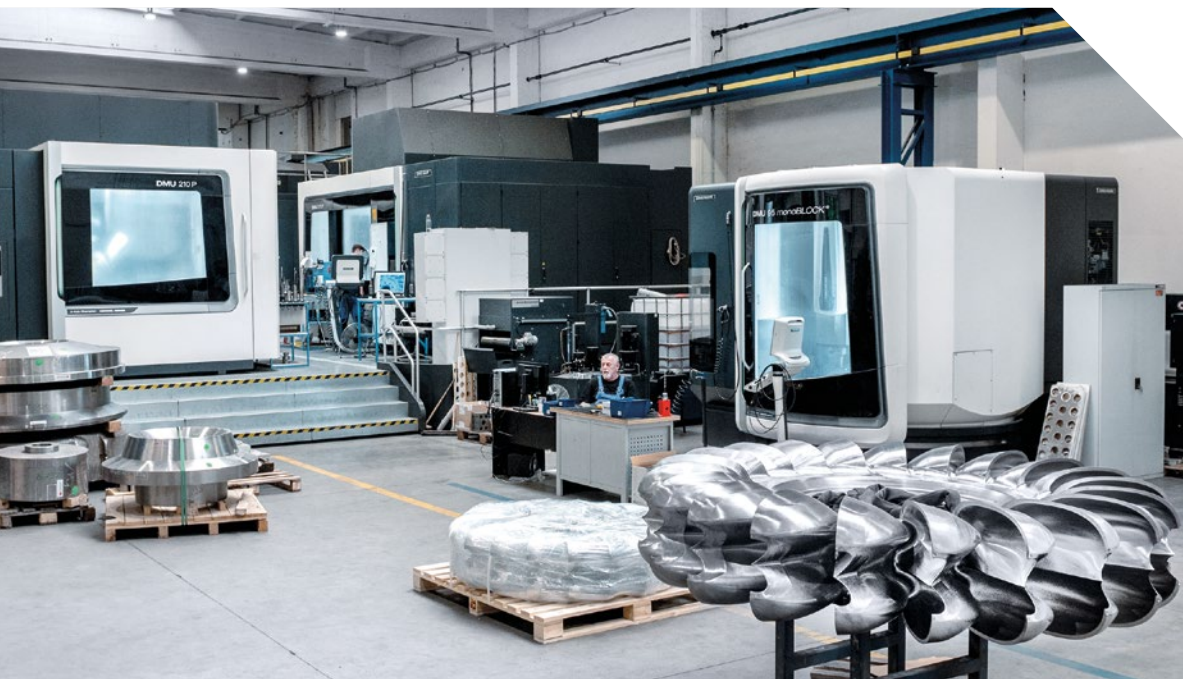
CNC Tvar每年生产300多件水轮，共使用13台DMG MORI机床进行生产。其中的90%是佩尔顿水轮和混流式水轮的转子。
