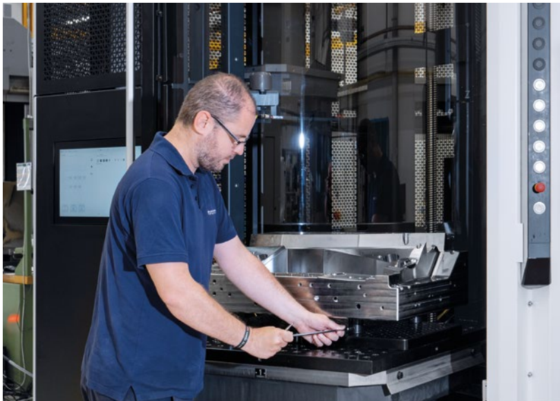
PH Cell 2000:我们在生产的同时,在这里准备大量托盘,最大限度缩短停机时间,包括夜班时。
