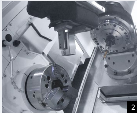
可在机床内更换卡盘夹爪
