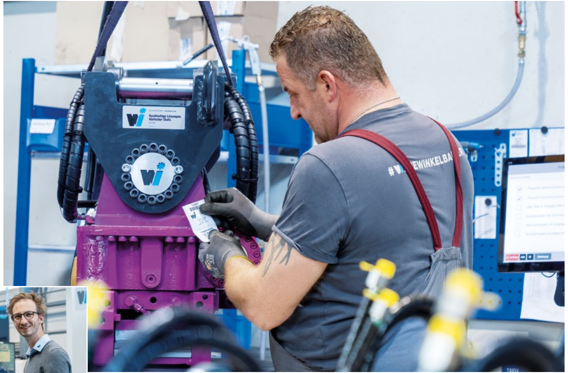
组装中的光学和功能测试：TULIP自动生成测试报告。
