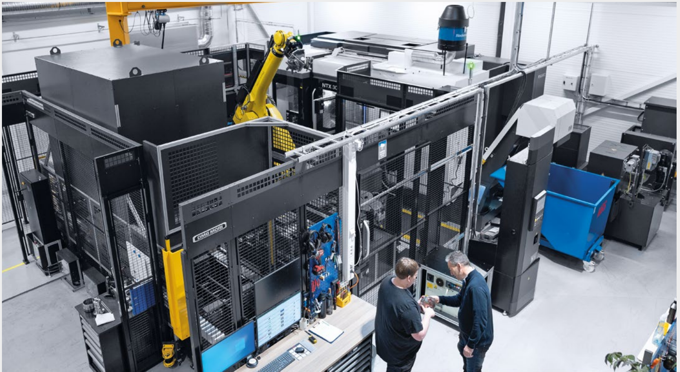
搭载MATRIS工件运送自动化系统后，NTX 3000车/铣复合中心现在可两班无人值守生产。灵活性非常高，甚至支持批量小于15件的生产。
