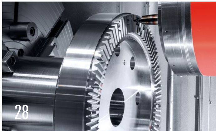
在通用型机床上切削齿轮 Kumera Antriebstechnik GmbH (奥地利) 工艺整合: 车/铣复合 + 齿轮切削
