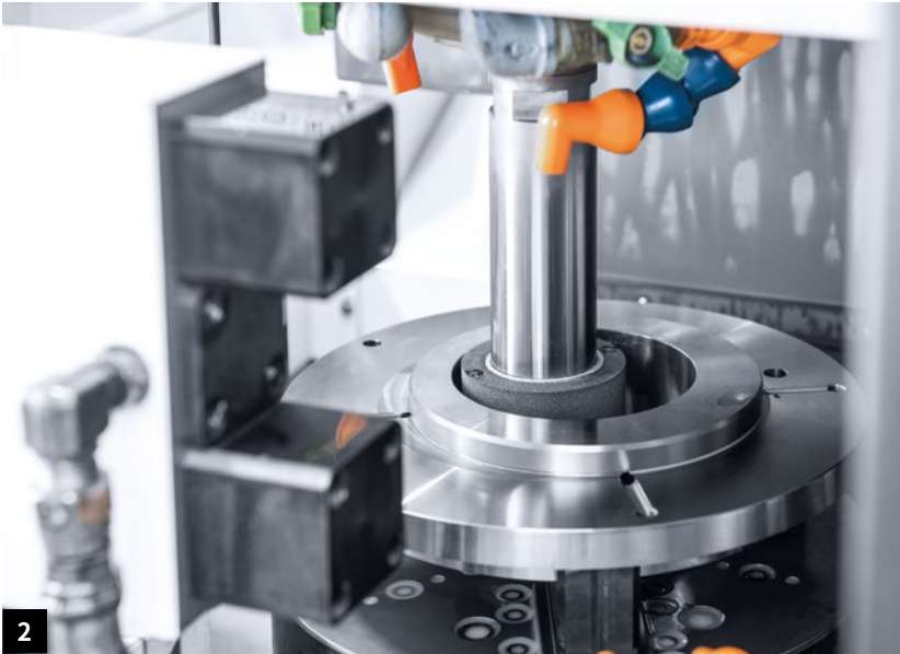
1. Richter Feingerätebau授权签字人Thomas Strauß(右)和授权签字人/技术管理总监Horst Hoferichter 2. IGV-3NT配内圆和外圆磨削主轴,可一次装夹磨削内圆、外圆和平面 3. 2022年,DMG MORI在Richter Feingerätebau安装了一台IGV-3NT磨床,包括量身定制的自动化解决方案 4. 加工后,测头检测每个工件
