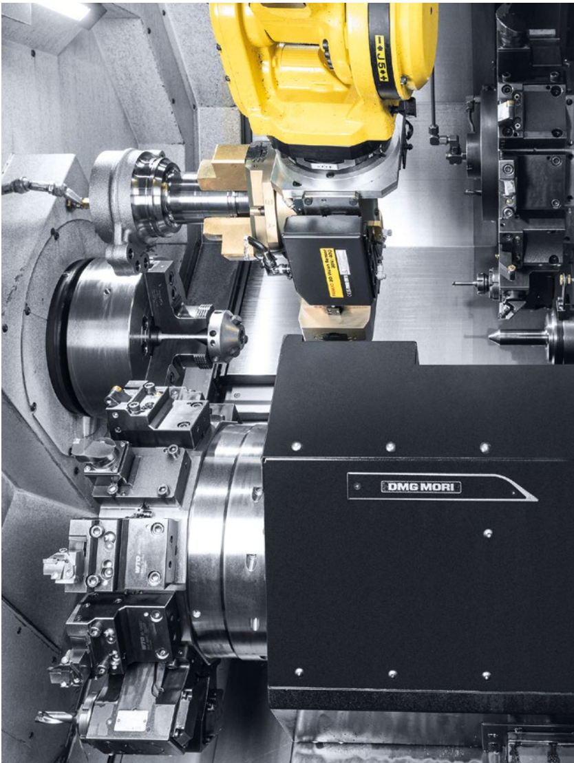
NZX 2500车削中心的双刀塔配置提高短轴加工速度达50%。
