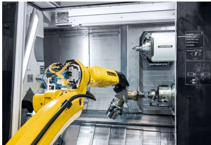
两个工件同时加工:一旦工件在主轴上完成加工,立即用Robo2Go将工件转到副主轴上加工,装夹新毛坯。
