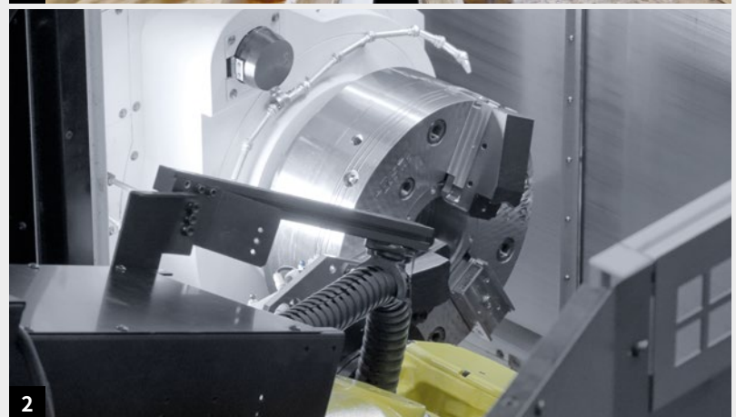
1. A/B: 用欧版托盘提供毛坯和取出成品件 C: 7位存放机器人抓手，可自动更换抓手，用于更换不同的工件，或更换卡盘夹爪。 2. 自动更换主轴和副主轴上的夹爪。为此，生产单元配60存放位，每个存放位可存放一套3个卡盘夹爪。
