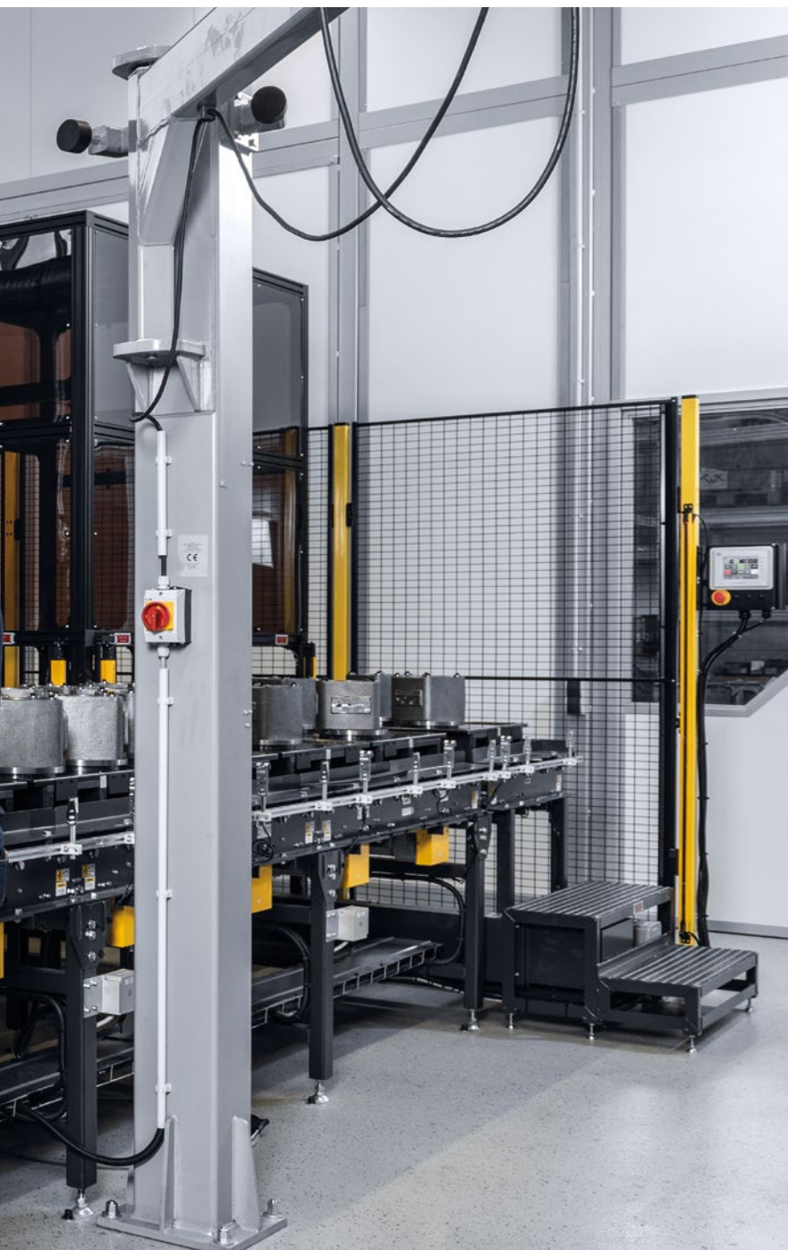
摄像头拍摄工件在平台上的准确位置。机器人基于图像高精度地抓取工件。
