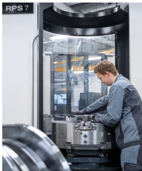
电动化的智能卡盘，夹持敏感工件。
