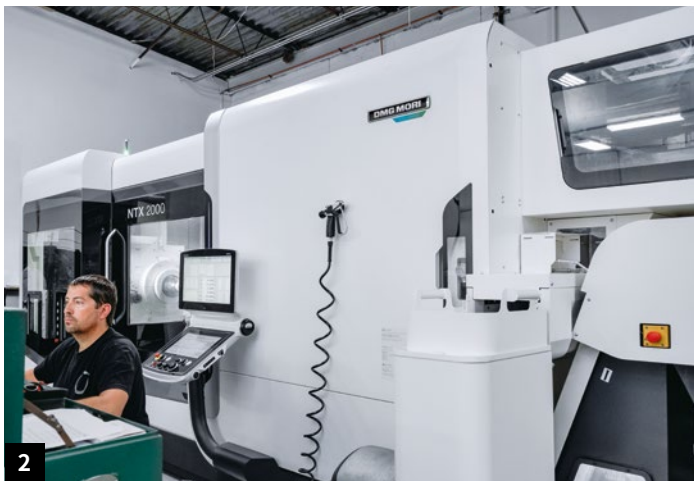
1. 部分Ouroboros员工在NTX 2000前 2. NTX 2000可6面车 / 铣复合完整加工, 工件尺寸可达 \phi 670 \times 1,538 mm 3. 对于 \phi 630 \times 600 mm和300 kg的小工件, Ouroboros选用第三代DMU 50铣削加工中心加工
