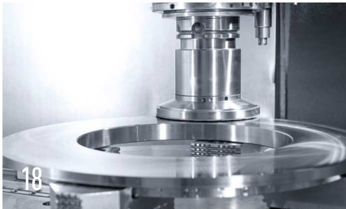
用金刚石加工金刚石 Tyrolit - Schleifmittelwerke Swarovski AG & Co KG. (奥地利) 工艺整合: 铣/车复合 (FD) + 磨削
