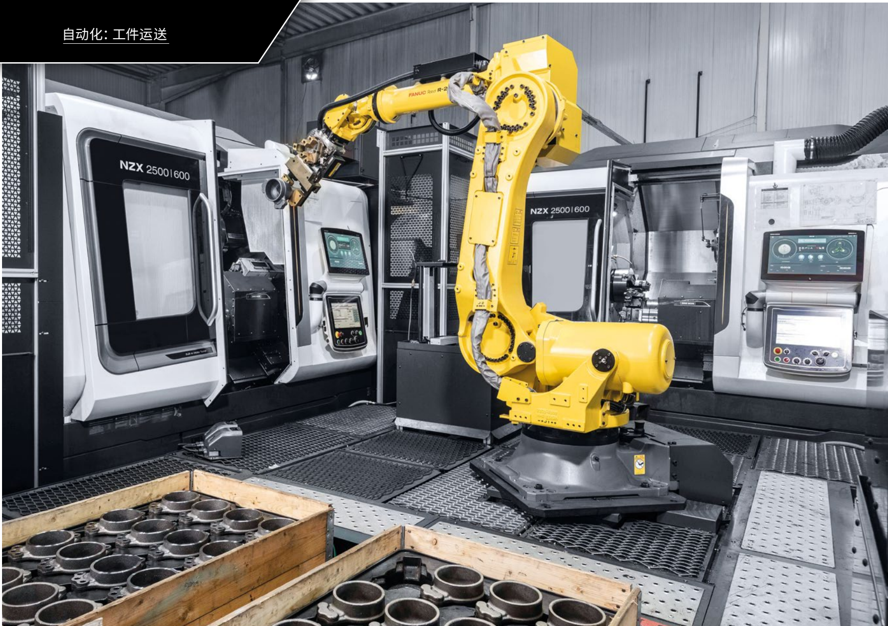
配视觉系统的机器人将左版和右版短轴分别送入两台NZX 2500车削中心并从中取出。
