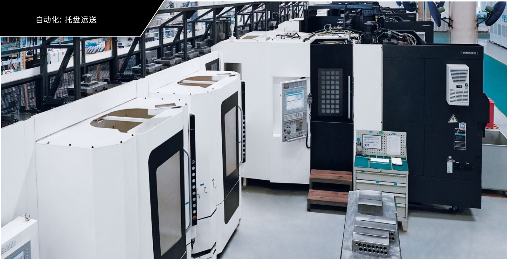
LPP直线托盘库系统之一:48盘位的LPP直线托盘库,2个装夹位和4台NH 5000 DCG卧式铣削加工中心。
